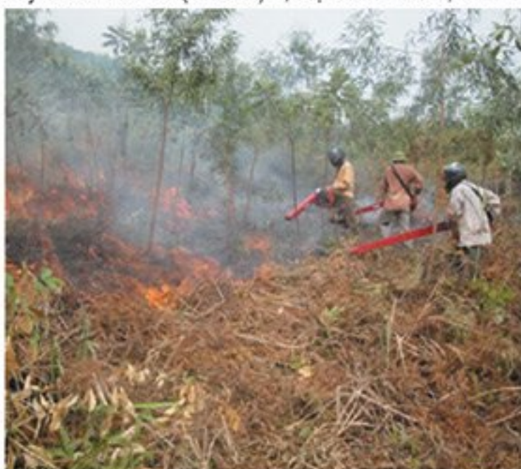
Hình 3: Thực nghiệm máy chữa cháy rừng bằng sức gió.
