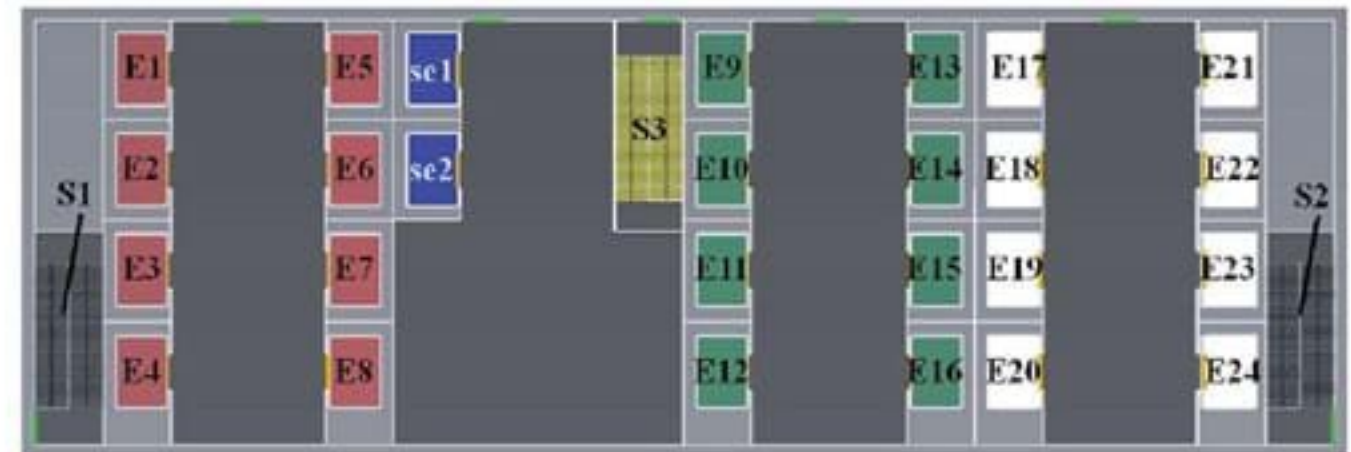
Hình 3. Khu vực thang thoát hiểm tại tầng 1 (sảnh) của tòa nhà.
