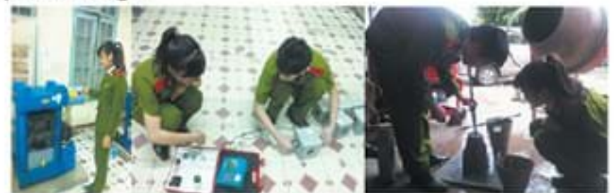
Hình 3: Kiểm tra độ sụt và cường độ bằng máy nén bê tông MATEST, máy siêu âm
