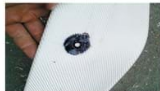
Hình 3: Lỗ trên thân vôi đường kính 5mm
