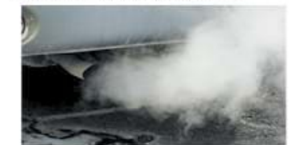
Hình 4. Khí xả động cơ có màu trắng
