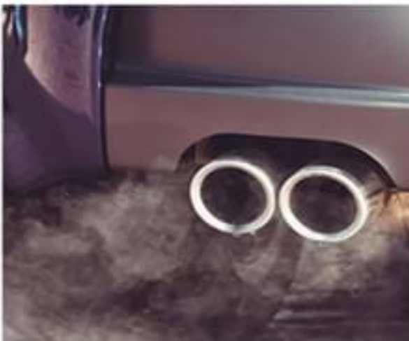
Hình 1. Khí xả động cơ không màu hoặc có màu nâu nhạt.
