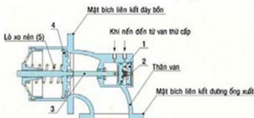
Hình ảnh và cấu tạo của van xả đáy sử dụng khí nén
