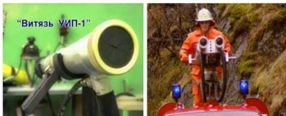
Hình 2. Thiết bị chữa cháy phun nước dạng sương mù tốc độ cao
