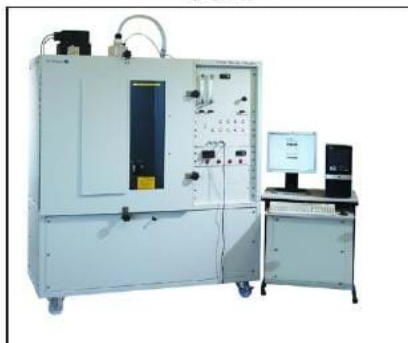
Thiết bị SDC xuất xứ từ Anh được lắp đặt và vận hành tại Trường Đại học PCCC.
