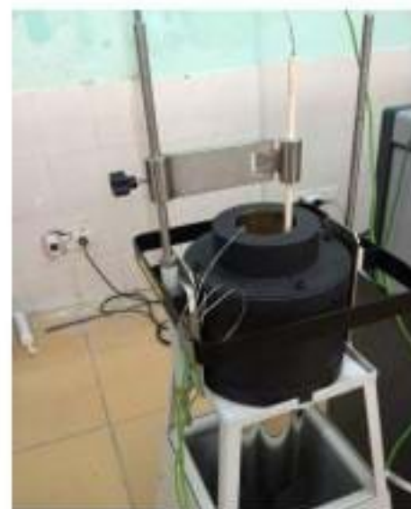
Lò đốt dạng ống của thiết bị xác định tính cháy và nhóm cháy của vật liệu xây dựng
