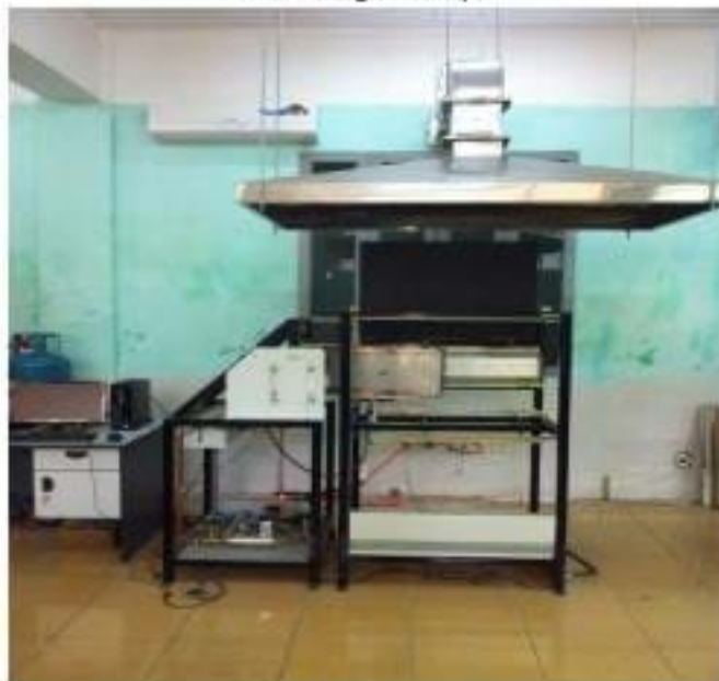
Thiết bị xác định tính cháy lan trên bề mặt vật liệu xây dựng.
