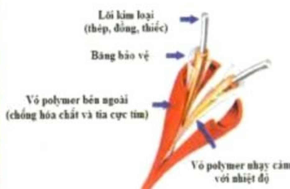
Cấu tạo của cáp báo cháy nhiệt
