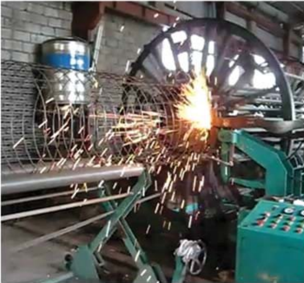
Vảy hàn với nhiệt độ cao gây ra cháy khi tiếp xúc với các vật liệu cháy.
