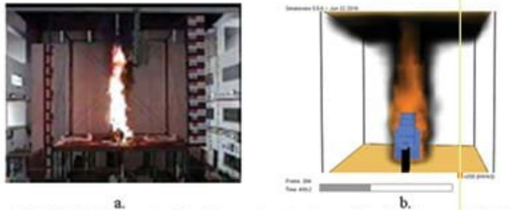
Hình 2. Mô phỏng quá trình cháy xe máy của thực nghiệm (a) và trong FDS (b)
