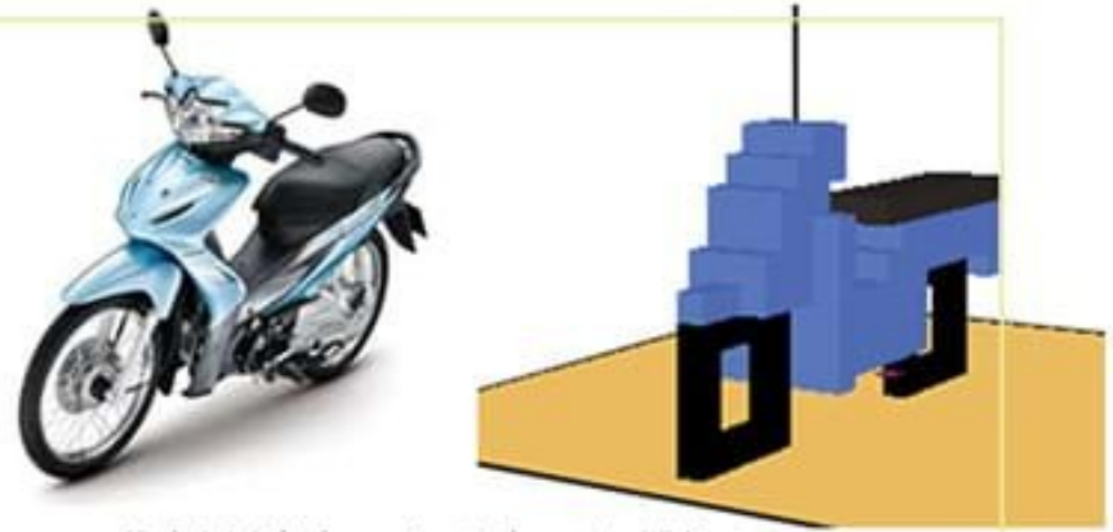
Hình 1. Mô hình xe máy xây dựng trên FDS
